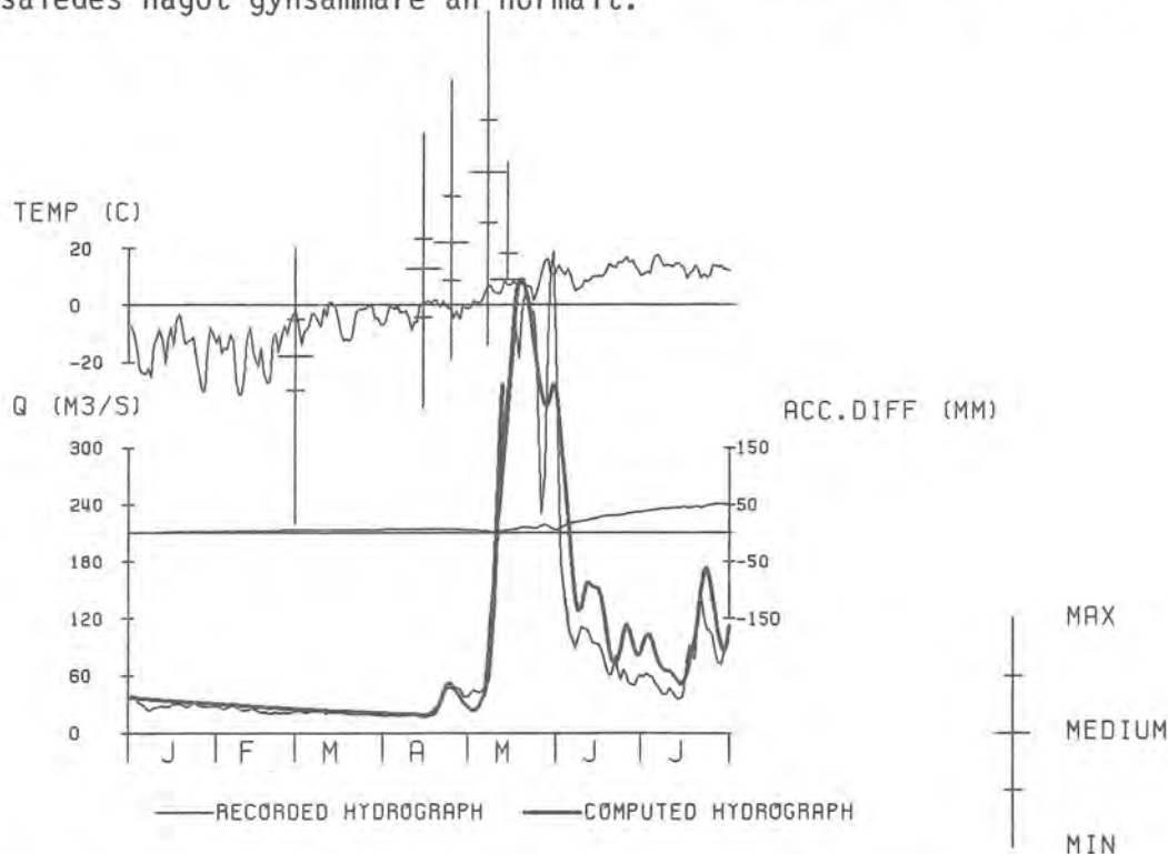
Figur 36. Framkörning av HBV-modellen över vårfloden samt prognoser på högsta flödestoppen för Stadarforsen.
