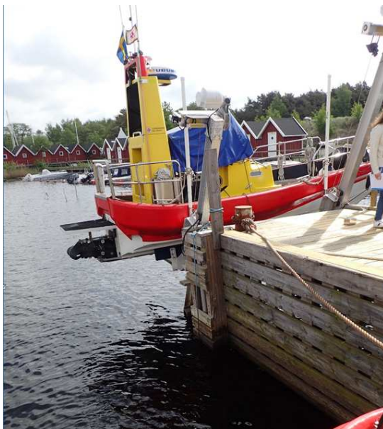
Figur 27. Foto av vattenståndsmätaren i Falkenberg. Den sitter inbyggd i träkonstruktionen i hörnet av bryggan. Djupet är 3 meter på platsen. Foto: SMHI.
