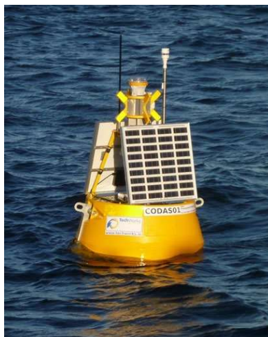
Fig. 46. SMHI driver tillsammans med Göteborgs universitet en oceanografisk mätboj i Kosterfjorden. Sensorer för klorofyllfluorescens (ett grovt mått på mängd växtplankton), syre, salthalt och temperatur är monterade på ca 1 m djup skickar data en gång i timmen.
